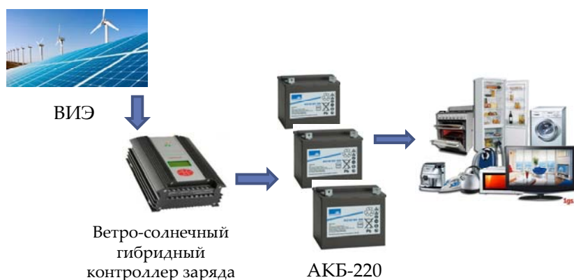
Рис. 1. Электроснабжение бытовых потребителей постоянным током
