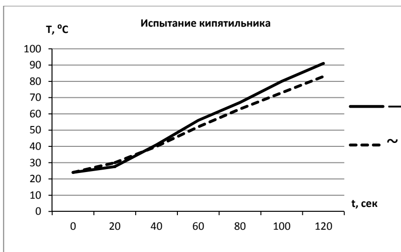
Рис. 4. Результаты опыта нагревания жидкости
